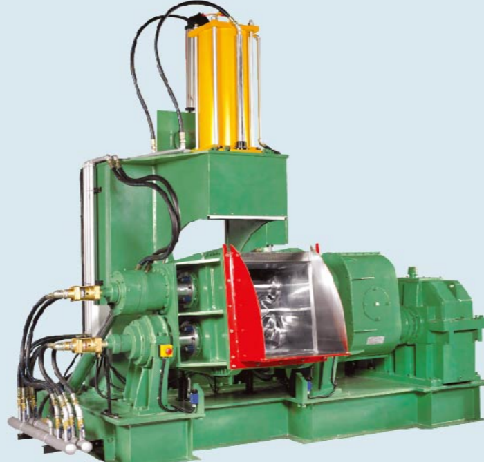
背投式(油壓缸式翻斗) Back Feed(Hydraulic Tilting)
