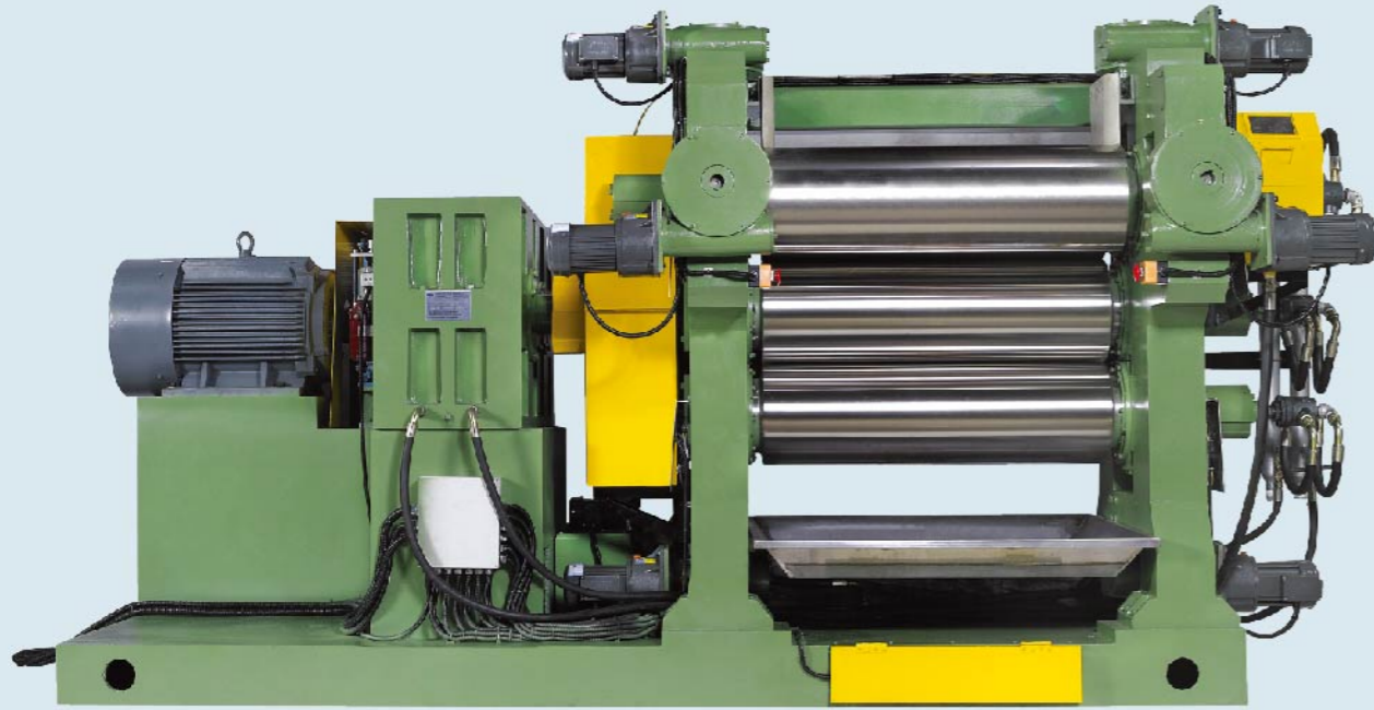
12寸四輓，單電機，單調整，壓延機
